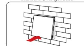
Den Wandschalter an der oberen Kante einklicken lassen und danach die untere Kante leicht drücken bis diese ebenfalls in den Controller-Sockel einklickt
