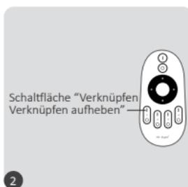
Drücken Sie die Taste " 1 " 5 Mal innerhalb von 3 Sekunden, wenn das Licht an ist.
