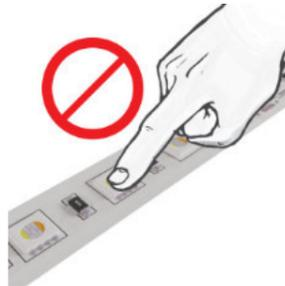
Berühren Sie so wenig wie möglich die Oberfläche des LED-Streifens um eine mögliche Beschädigung des LED-Streifens zu vermeiden.
