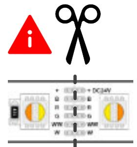
**i** Die Abdeckung und der LED Streifen hat die gleiche Länge wie das Aluprofil. Beides kann mit dem passenden Werkzeug auf die notwendige Länge gebracht werden.
