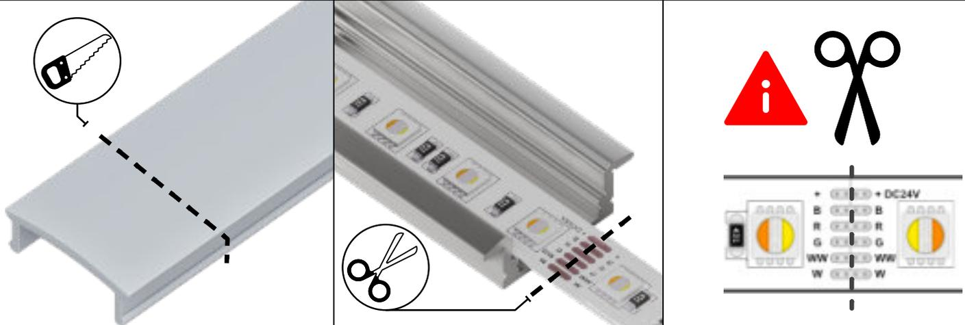
**i** Die Abdeckung und der LED Streifen hat die gleiche Länge wie das Aluprofil. Beides kann mit dem passenden Werkzeug auf die notwendige Länge gebracht werden.
