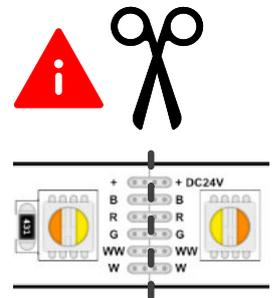
**i** Die Abdeckung und der LED Streifen hat die gleiche Länge wie das Aluprofil. Beides kann mit dem passenden Werkzeug auf die notwendige Länge gebracht werden.
