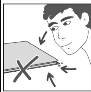
Während der Verlegung die Elemente aus mindestens drei oder mehr Paketen mischen und auf Materialfehler überprüfen. Elemente mit sichtbaren Materialfehlern dürfen nicht verlegt werden.
