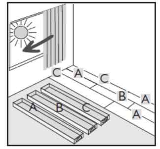
Schneiden Sie die Elemente der letzten Reihe auf Maß. Wenn das Element nicht von oben eingewinkelt werden kann, schneiden Sie die Nase der unteren Nutwanne ab, und tragen Sie etwas wasserfesten D3-Weißleim auf. Anschließend setzen Sie die Diele einfach ein. Berücksichtigen Sie hierbei auch den einzuhaltenden Randabstand.
