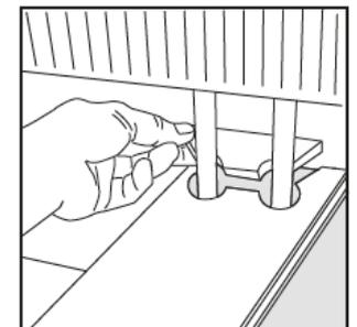
Türen: Markieren Sie mittels Elementabschnitt oder anhand eines gedrehten Elements die Schnittmarke an der Türzarge. Passen Sie die Türzarge mit geeignetem Werkzeug entsprechend an.
