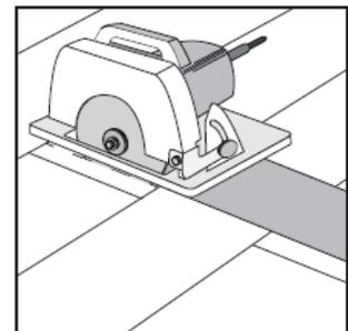
Zur Vorbereitung des Ersatzelements schneiden Sie sowohl an der Stirn-, als auch an der Längsseite vorsichtig die Feder ab, sodass die Verriegelungsnut nicht beschädigt wird.
