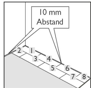
Das 4. Element zunächst längsseitig mit der Nut unter die Feder des 3. Elements winkeln. In diesem angewinkelten Zustand das 4. Element an die Stirnseite des 1. Elements heranschieben, bis die Stirnseiten beider Elemente passgenau aneinander stoßen. Nun verriegeln Sie wiederum die längsseitige Verbindung durch absenken und gleichzeitig die stirnseitige Verbindung durch Eindrücken bis diese spürbar einrastet. Wir empfehlen der Einsatz eines geeigneten Gummihammers und Schlagklotzes.
