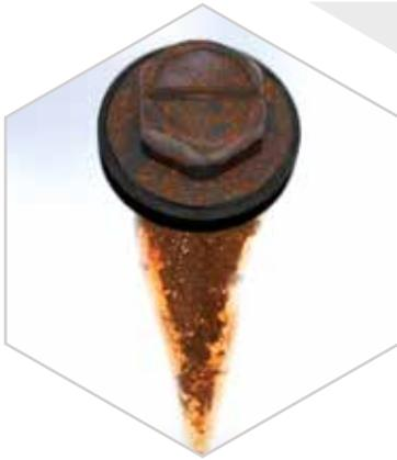
Qualitativ minderwertige Befestigungsteile erhöhen das Korrosionsrisiko. Aufgrund der physikalischen Geometrie der Befestigungselemente und anderer rauen Oberflächen, können aggressive Verbindungen wie Chloride (Salze), Säuren (Schwefelsäure) und alkalische Lösungen (Reinigungslauge) besser haften. Die Wechselwirkung der Verbindungen mit der UV-Strahlung beschleunigt den Lochfraß und die Spaltkorrosion an diesen Stellen drastisch.
