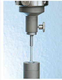
Test Nietdornausdrückkraft Mandrel push out test Essai de retenue de la tête de rivet
