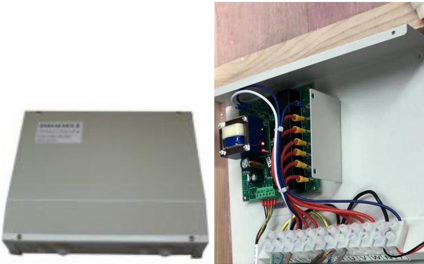
Das weiße Kabel muss an die grüne Platine angeschlossen werden.
